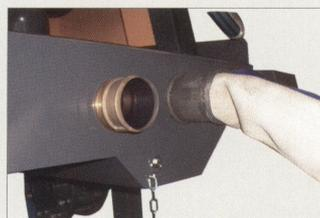
Sobre el lado posterior del compartimento técnico está presente una válvula de conexión a la manguera de riego protegida por un cierre metálico.
