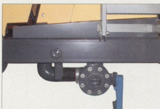
Válvula de carga de mariposa con conducto en PVC. La solución puede ser descargada desde la misma válvula por gravedad.
