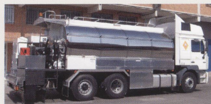
CEAG/101-REXN Rampa de 5 metros, calentamiento de rampa por aceite termofluido, quemador eléctrico de gas-oil y caja abierta para herramientas
