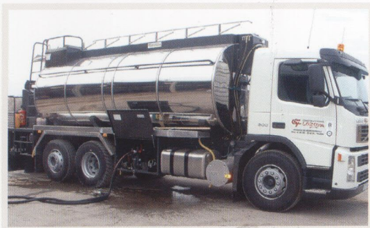
CEAG/11-REXN Rampa de 5 metros, combinada con emulsión, agua y gas-oil
