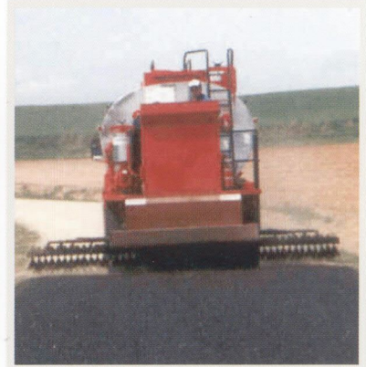
CRB/11-REXM Rampa de 5 metros apertura de difusores mecánicos
