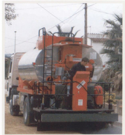
CRB/08-RLXN Rampa de 2,5 metros, apertura neumática de difusores
