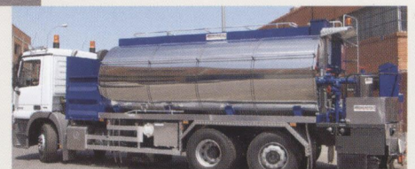
CEAG/101-REXN Rampa de 5 metros, calentamiento de rampa por aceite termofluido, quemador eléctrico de gas-oil y caja abierta para herramientas
