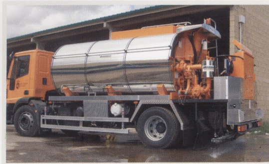
CRB/08-RLXN Rampa de 3,5 metros, apertura neumática de difusores
