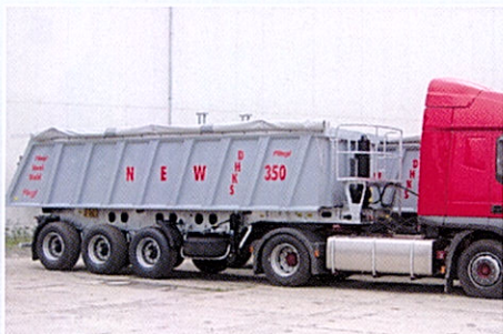
DHKS 350 / 24 Bañera de acero con perfiles personalizados.
