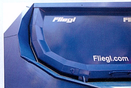
La bañera de acero está fabricada en forma de monocasco y con acero de alto nivel antidesgaste HB 450
