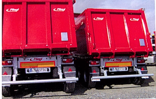
Bañera con puerta trasera exterior pendular
