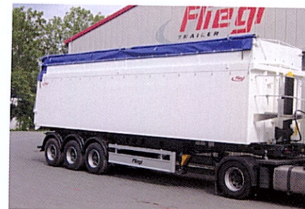
DHKA 350 / 45 con sobrelaterales para 60 m 3
