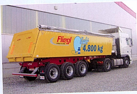
Semirremolque basculante Light* con bañera de aluminio de 27 m 3 , sólo 4.800 kgs. de tara. *) para el Light, ancho de suspensión 1.300 mm / ancho de vía de 2040 mm
