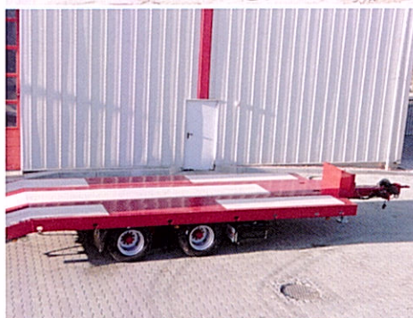
Remolque góndola tandem para el transporte de maquinaria de construcción con prolongación delantera
