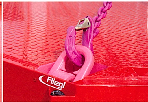
Amarre asegurado con anillas de enganche tipo RUD
