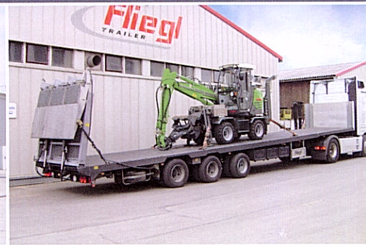
Semirremolque de cama inclinada en variantes más diversas. Por ejemplo con rampas continuas
