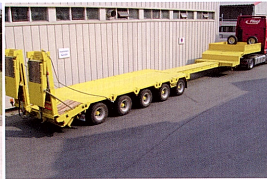
Semirremolque Góndola extensible con fijación en diferentes longitudes, y con una configuración de ejes a su elección.
