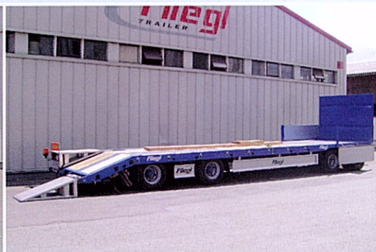
Remolque góndola 4 ejes con plataforma recta y rampas plegables de aluminio en la parte trasera
