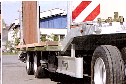
Ensanchamiento telescópico hasta los 3000 mm aprox. de ancho total.
