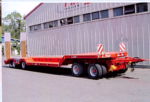
Remolque góndola con una gran cuna de ruedas
