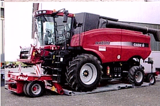
ZTS 200 especial, para el transporte de cosechadoras. Altura de cama de 250 mm, el eje trasero es desmontable para cargas casi al nivel del suelo.
