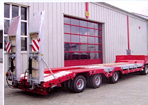
Remolque góndola de 5 ejes con cuna de ruedas y eje autodireccional
