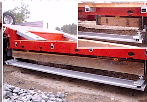
Cajón lateral para alojamiento de las maderas de ensanchamiento de la góndola
