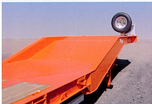
Cuello de cisne con rampa de acceso
