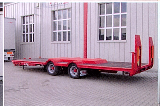
Remolque tandem góndola, construido especialmente para el transporte de maquinaria agrícola.
