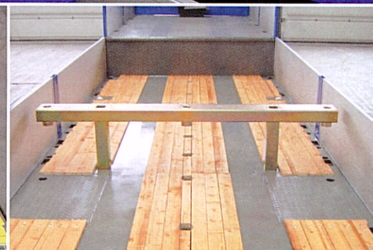
Caballete para igualar la altura de carga entre el cuello de cisne y la cama de la góndola
