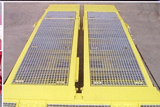
Rampas tipo rejilla dentadas. Rampas divididas y desplazables hidráulicamente lateralmente.
