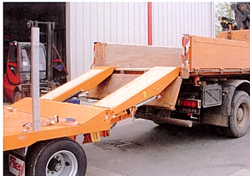
Más utilidad para Ud.: Rampas de acceso del remolque góndola sobre el vehículo tractor.
