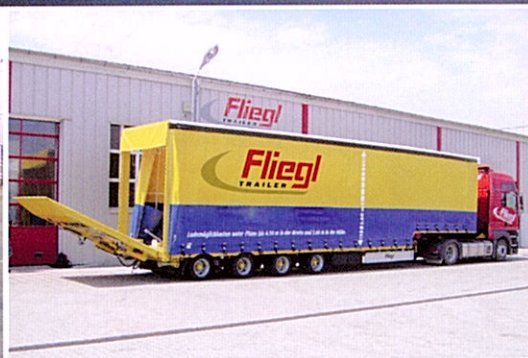
Semirremolque góndola de 4 ejes con lonas, con 3,50 m de altura interior y con un ensanchamiento de hasta 4 m
