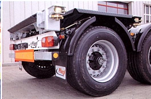
Protección transversal del chasis estable. Barra antiempotramiento y soporte de pilotos están montados por separado y bien protegidos. Pueden sustituirse fácilmente en caso de accidente.
