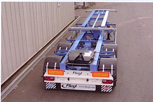
Chasis Combi, para países escandinavos: 20 pies delante, fácilmente desplazable para realizar la carga y descarga enrasada atrás y un enganche adicional para otro semirremolque
