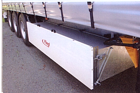
El portapalets es amplio por las muchas variantes que tiene, lo que permite que se puedan transportar los palets vacíos de manera limpia y segura. Opcionalmente, se puede solicitar en la configuración de su equipamiento el portapilares.
