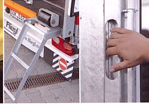
Protección óptima para golpes y escalera, que corresponden a la norma BG. Junto con la manivela empotrada le facilita el ascenso a la superficie de carga.
