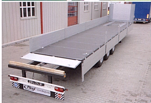
Semirremolques para materiales de construcción con extensión trasera y twist lock para contenedor
