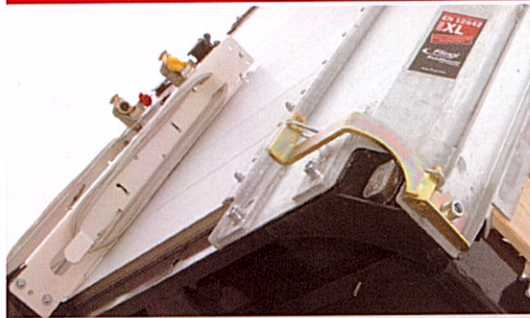
Pared frontal certificada con soporte para cable TIR
