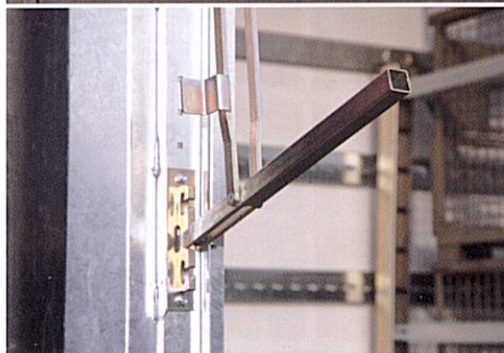
Elevación manual: Dos alturas de elevación mediante la palanca de manejo.
