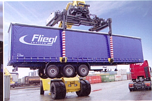
Bajo petición, Fliegl Trailer también efectúa vehículos para el transporte combinado por ferrocarril. Por supuesto FLIEGL cumple las codificaciones propias del transporte por tren.
