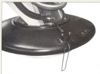
Sensor falta de sal con visualización en el display de la cabina del conductor.
